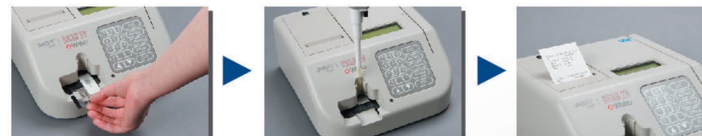
①ドライ試薬カードを挿入 ②希釈検体(25μL)を注入 ③結果をプリントアウト
