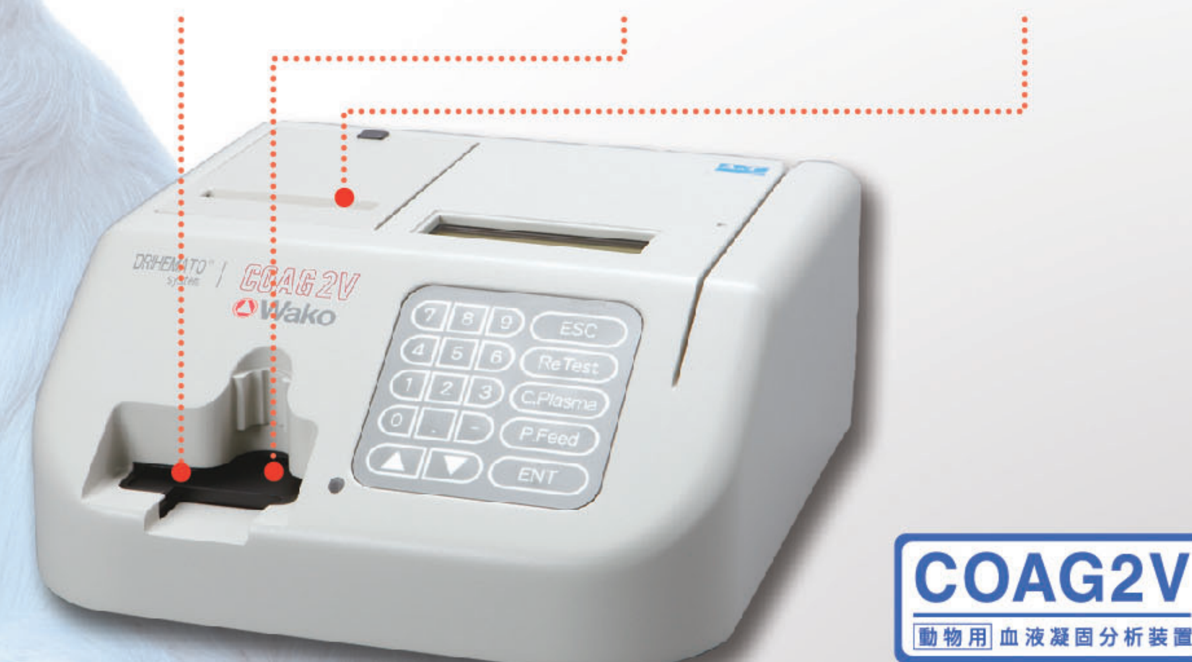
①ドライ試薬カードを挿入 ②希釈検体(25μL)を注入 ③結果をプリントアウト
